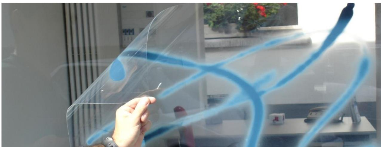
Die Ag 701 ist eine wiederabziehbare Schutzfolie die bei starker Verschmutzung bzw. Verkratzung einfach von der Fläche abgezogen und ersetzt werden kann. Durch die Folie wird das darunterliegende Glas vor Kratzern und Graffiti-Schmierereien geschützt.
